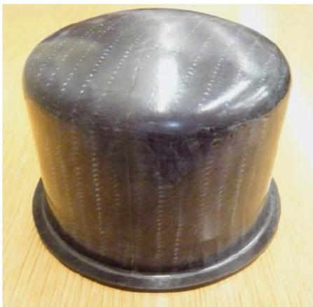
Abb. 3: PEEK-Composite-Spalttopf
